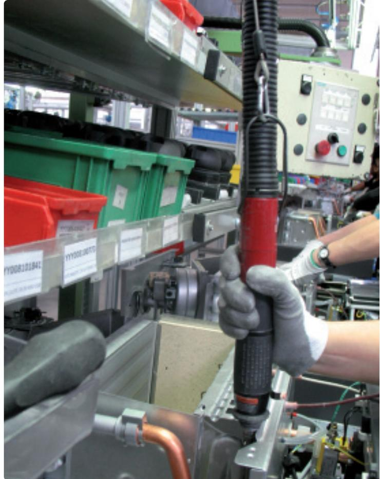
Aufgrund des großen Drehmomentbereiches (0,5 bis 6,5 Nm) kann ein Modell für eine Vielzahl von Aufgaben eingesetzt werden. Der Desoutter Schrauber SC2 ist standardmäßig mit einem integrierten Anschluss für die Verwendung mit einem POSCO-Gerät (System) oder einem FAS3000 Schraubprozess Überwachungssystem (Loszählung, SPS) ausgestattet.
